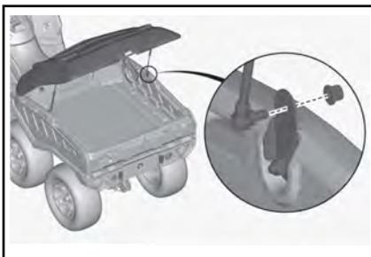
9. Installare la parte superiore dell'ammortizzatore avvitandola nella sede.
