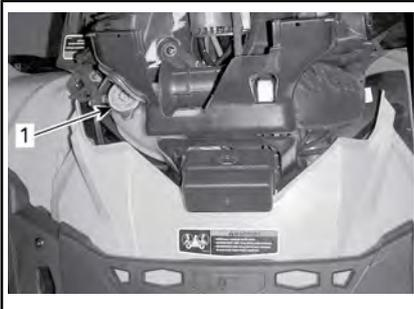
1. Tappo del serbatoio liquido refrigerante motore
