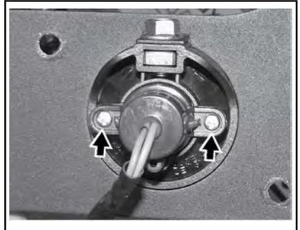
**SVITARE LE VITI DI FISSAGGIO DALLA LAMPADINA DELLA FRECCIA POSTERIORE**
