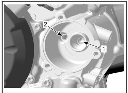
1. Einlass-Bohrung der Ölpumpe zum Ölfilter
