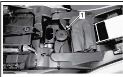
1. Behälter für Bremsflüssigkeit der hinteren Bremse
