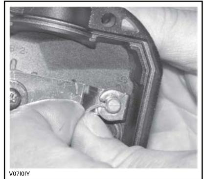
Entfernen Sie die Seitenabdeckung der Drosselklappe.
