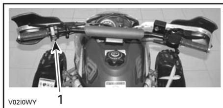
1. Interrupteur multifonctionnel
