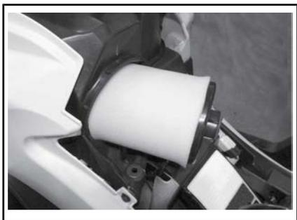
**RIMOZIONE DEL FILTRO DELL'ARIA**
