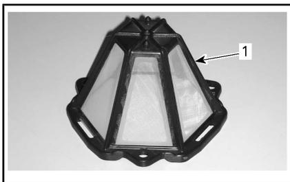
1. Filtro dell'aria CVT (tipo clip-on)
