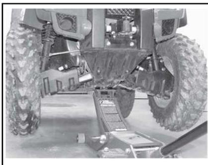
**CONFIGURAZIONE TIPICA - PUNTO ANTERIORE SUPERIORE DI ATTACCO**
