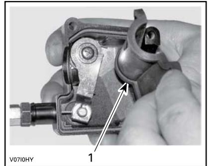
1. Protezione interna dell'alloggiamento
