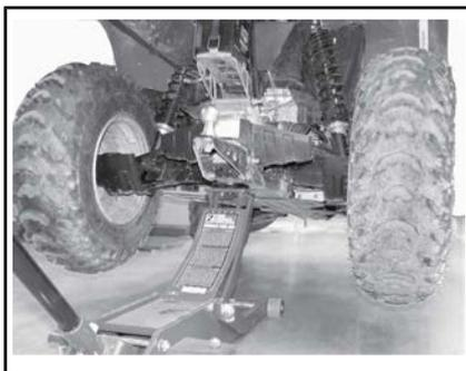
**CONFIGURAZIONE TIPICA - PUNTO POSTERIORE SUPERIORE DI ATTACCO**
