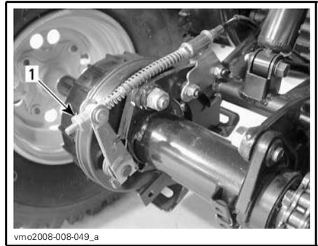
1. Dispositif de réglage de câble de frein
