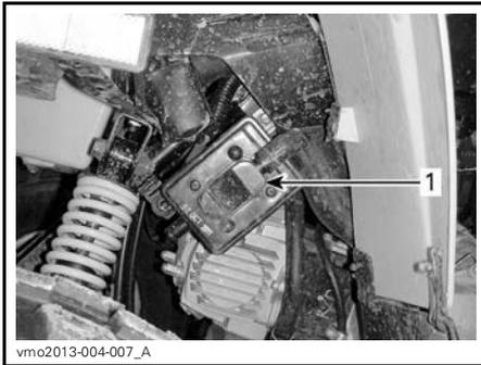
1. Soupape d'injection d'air
