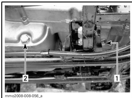
**BOUCHON DE VIDANGE - CÔTÉ GAUCHE DU MOTEUR**
