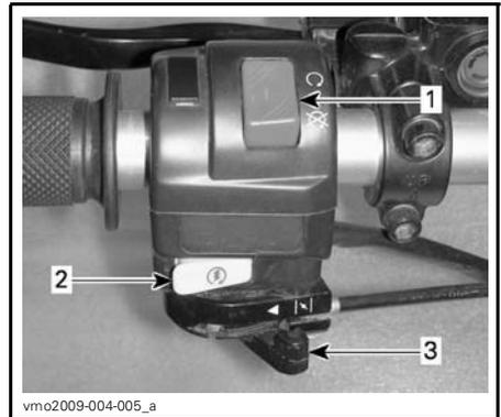
1. Interrupteur d'arrêt d'urgence du moteur
