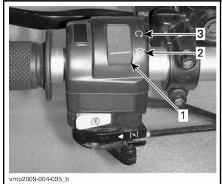
1. Interrupteur d'arrêt d'urgence du moteur
