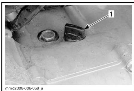
**BOUCHON DE REMPLISSAGE - CÔTÉ GAUCHE DU MOTEUR**
