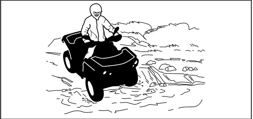
Si los frenos están húmedos, la capacidad de frenado del vehículo se ve afectada. Asegúrese de que se sequen los frenos; para ello, acciónelos varias veces después de salir del agua, del barro o de la nieve con el vehículo. Tenga en cuenta la necesidad de una mayor distancia para el frenado.
