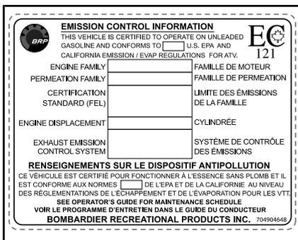
TÍPICO - UBICACIÓN: BAJO EL ASIENTO, SOBRE LA SECCIÓN SUPERIOR DEL BASTIDOR
