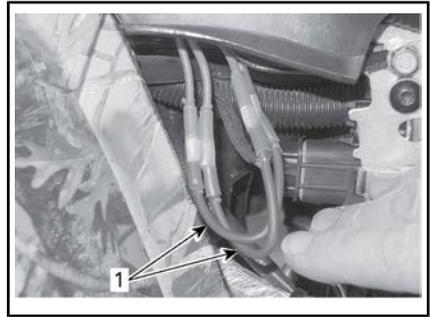
1. Conexiones de fusibles
