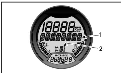
1. **AIR\_SUSP** (Luftfederung) wird angezeigt
