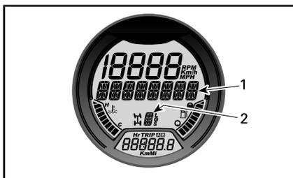
1. **AIR\_SUSP** (Luftfederung) wird angezeigt
