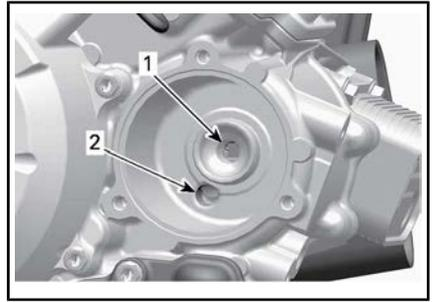
1. Auslass-Bohrung zur Ölspeisung des Motors
