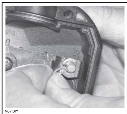
Entfernen Sie die Seitenabdeckung der Drosselklappe.
