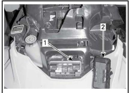
1. Vorderer Sicherungskasten
