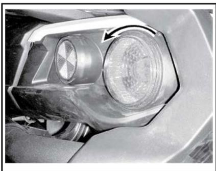
**RÜCKLEUCHTE ZUM ENTFERNEN GEGEN DEN UHRZEIGERSINN DREHEN**
