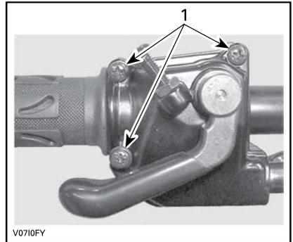
1. Diese Schrauben entfernen
