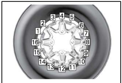
SITUAZIONE TIPICA - SEQUENZA DI SERRAGGIO FINALE
