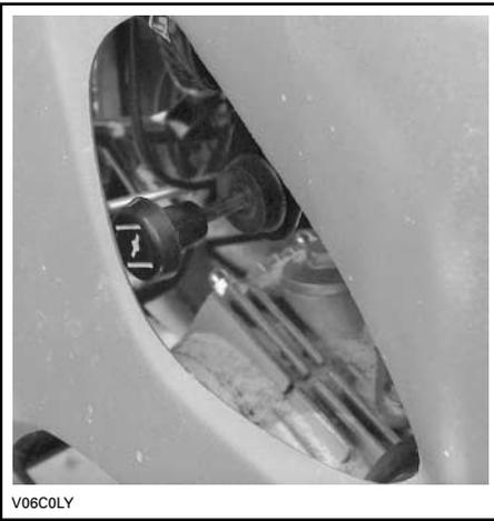
**CHOKE LEVER IN THE FULL CHOKE POSITION**
