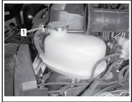
1. Tapón del depósito de refrigerante del motor
