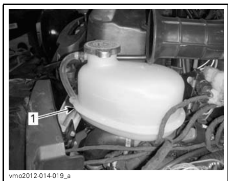
1. Réservoir de liquide de refroidissement
