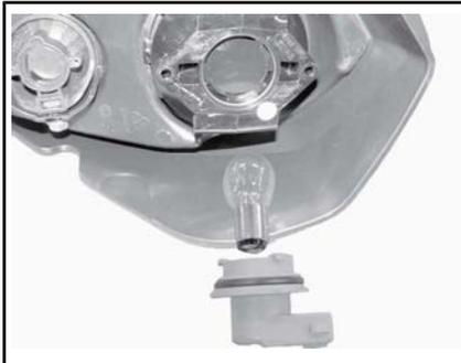
4. Entfernen Sie die Glühlampenfassung von der Schlussleuchte. Der Einbau erfolgt in der umgekehrten Reihenfolge des Ausbaus.
