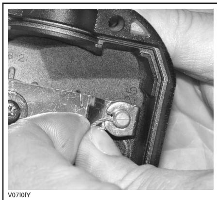
Rimuovere la copertura laterale del carburatore.
