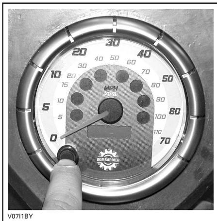
Premendo di nuovo il pulsante di selezione display si cambierà quest'ultimo in un contaore. Premere di nuovo il pulsante di selezione display per tornare al contachilometri.
