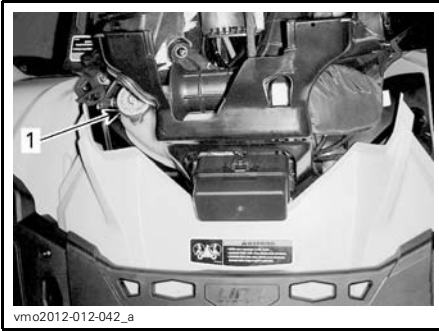
1. Réservoir de liquide de refroidissement
