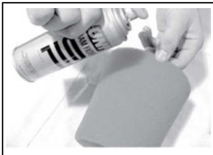
代表例 - フォームフィルターにオイルを塗布します。
