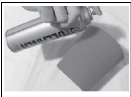
代表例 - フォームフィルターへの吹き付け
