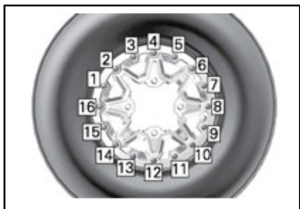
代表例 - 最後の締め付け順序
