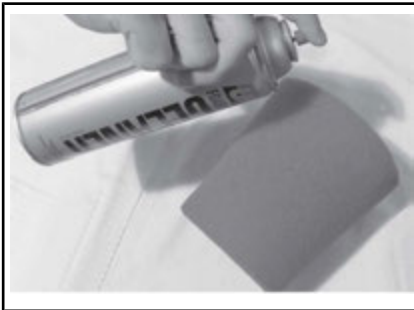
TÍPICO - ROCÍE EL FILTRO DE ESPUMA.
