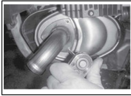
TÍPICO - RETIRE EL TUBO DE ESCAPE.
