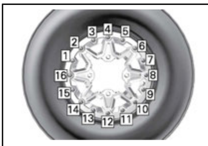
TYPBILD - SLUTLIG ÅTDRAGNINGSSERIE
