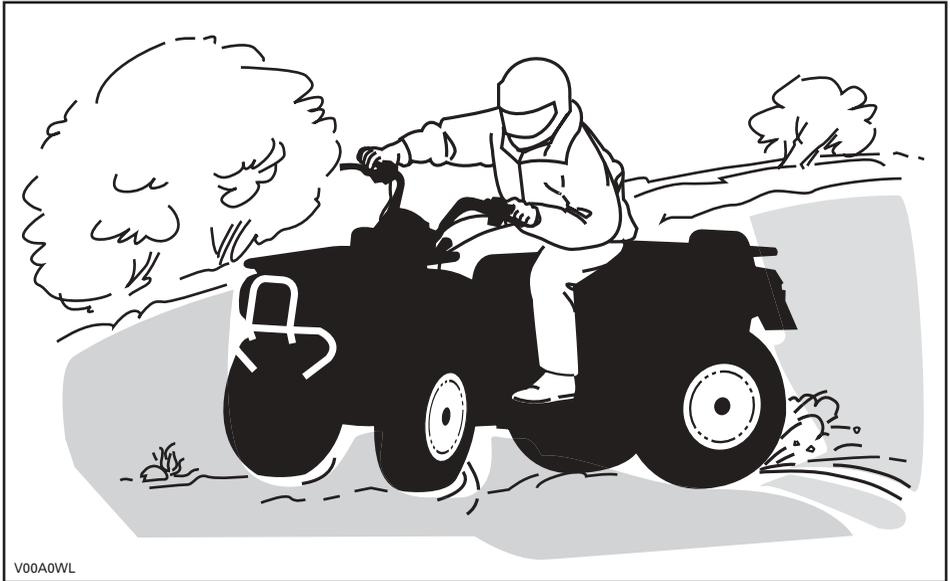
Si le véhicule se met à glisser, tourner le guidon dans le même sens que la direction du glissement jusqu'à ce que vous repreniez contrôle du véhicule. Ne jamais serrer les freins à fond ou bloquer les roues.
