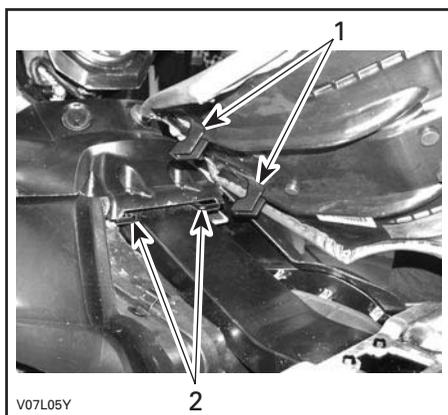
1. Insérer ces languettes dans le crochet
