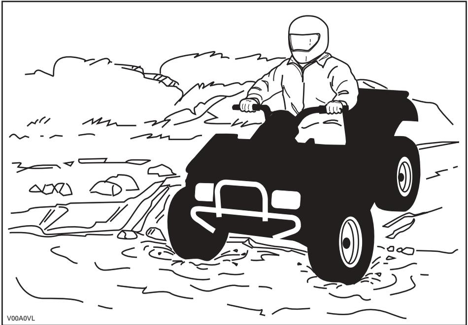
L'eau réduit la capacité de freinage. Après être sorti de l'eau, rouler à basse vitesse et actionner les freins quelques fois pour que la chaleur de la friction sèche les plaquettes.
