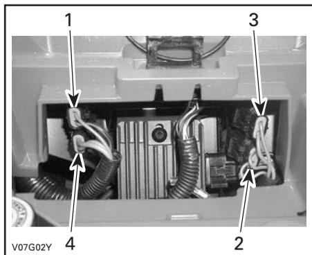
1. Accessoires (15 A) (prise de courant et alimentation auxiliaire)
