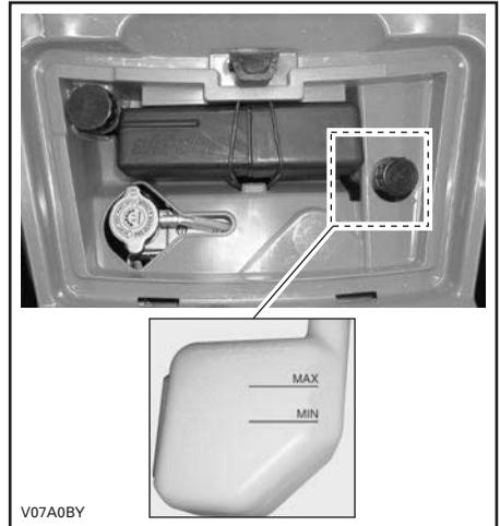
Le véhicule sur une surface de niveau, le niveau de liquide doit être entre les marques MIN. et MAX. du réservoir.
