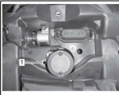
1. Behälter für Bremsflüssigkeit der hinteren Bremse
