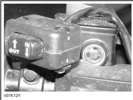
Examine el estado del fuelle de la palanca de freno. Compruebe si existen grietas, roturas, etc. Sustitúyalo si está dañado.
