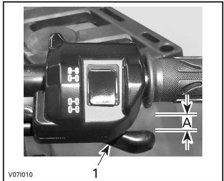
1. Palanca del acelerador
