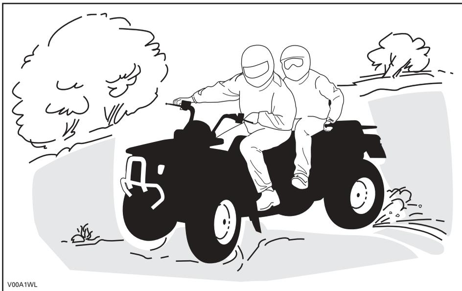
Si el vehículo derrapa o resbala, quizá resulte de utilidad girar el manillar en la dirección del deslizamiento hasta que vuelva a recuperar el control. Procure que no se bloqueen nunca los frenos ni las ruedas.
