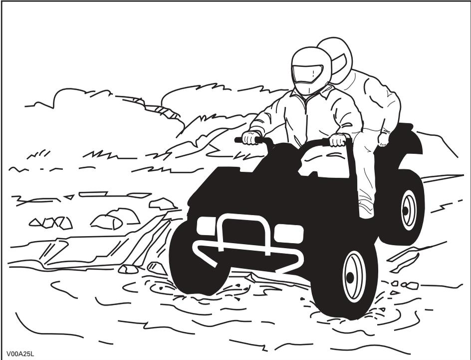
El agua afecta a la capacidad de frenado del vehículo. Asegúrese de que se sequen los frenos; para ello, acciónelos varias veces después de salir del agua con el vehículo. La distancia de frenado puede verse afectada si se lleva un pasajero. Reduzca prudentemente la velocidad cuando lleve un pasajero. Tenga en cuenta la necesidad de una mayor distancia para el frenado.
