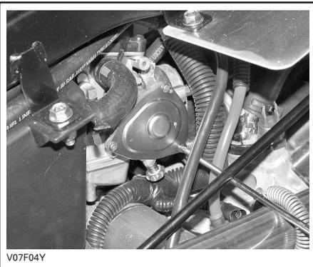
Inserte la aguja de la lata del lubricante en el extremo del ajustador del cable del acelerador.
