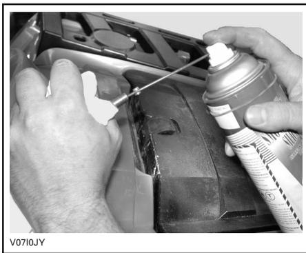
**NOTA:** Ponga un trapo alrededor del ajustador del cable del acelerador para prevenir salpicaduras de lubricante.
