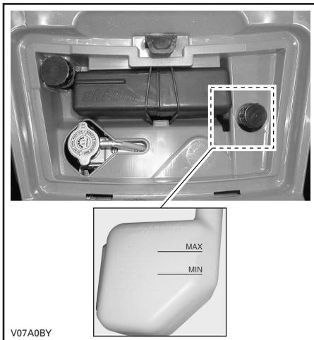
Con el vehículo en una superficie llana, el líquido debe encontrarse entre las marcas de nivel MIN. y MAX. que figuran en el depósito de refrigerante.
