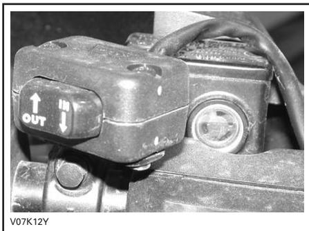
Controllare visivamente le condizioni del cappuccio della leva. Controllare che non ci siano rotture, strappi, ecc. Sostituire se danneggiato.
