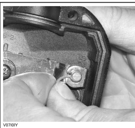
Rimuovere la copertura laterale del carburatore.
