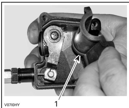
1. Protezione interna dell'alloggiamento
