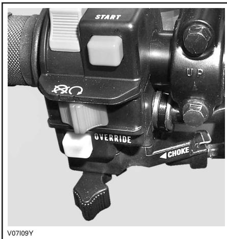
LEVA DEL DISPOSITIVO DELL'ARIA IN POSIZIONE COMPLETA
