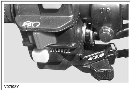
LEVA DEL DISPOSITIVO DELL'ARIA IN POSIZIONE OFF
