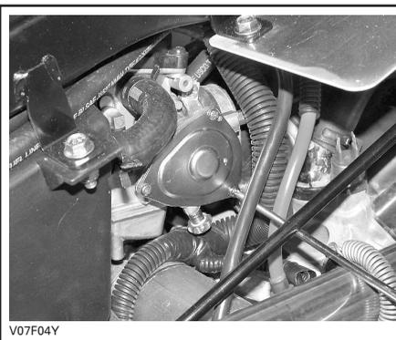
Inserire il beccuccio della bomboletta di lubrificante nel terminale del registro del cavo dell'acceleratore.
