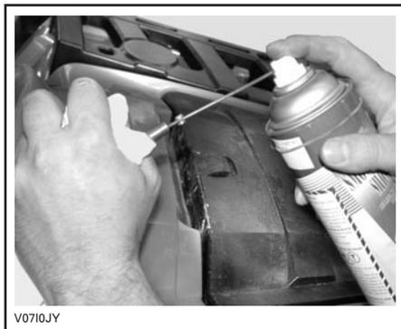
**REMARQUE:** Mettre un chiffon autour du tendeur de câble d'accélérateur pour éviter que le lubrifiant ne se répande.
