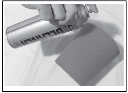
TYYPILLINEN – SUIHKUTA VAAHTOMUOVISUODATTIMEEN
