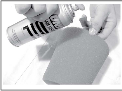
TYYPILLINEN – ÖLJYÄ VAAHTOMUOVISUODATIN
