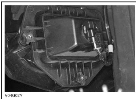
Tourner la douille de l'ampoule dans le sens antihoraire puis retirer le phare.
