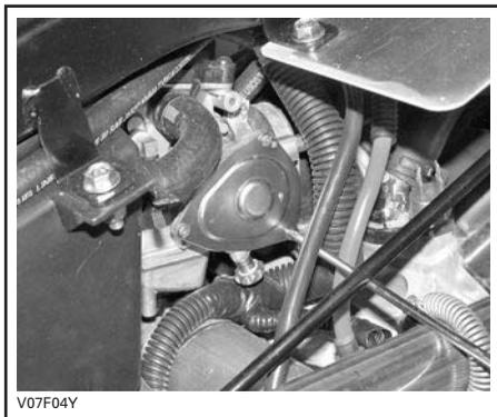
Insérer l'aiguille du vaporisateur dans l'extrémité du tendeur de câble d'accélérateur.
