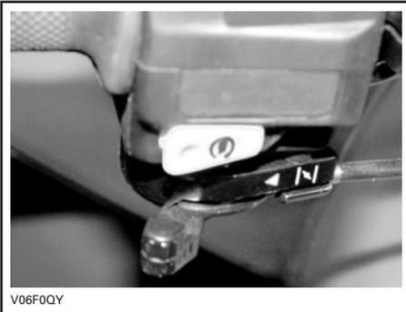
*CHOKE LEVER IN THE FULL CHOKE POSITION*
