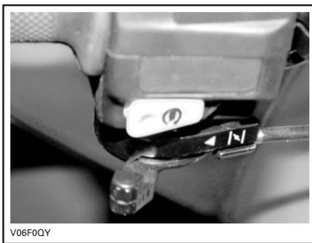
Appuyer sur le bouton de démarrage et le maintenir jusqu'à ce que le moteur démarre.
