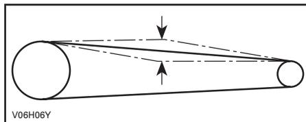
Tourner l'essieu dans le sens horaire pour réduire la tension et dans le sens antihoraire pour l'accroître.
