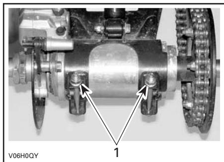
1. Boulons de blocage du tendeur de chaîne
