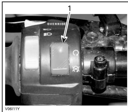
1. Interrupteur d'arrêt du moteur
