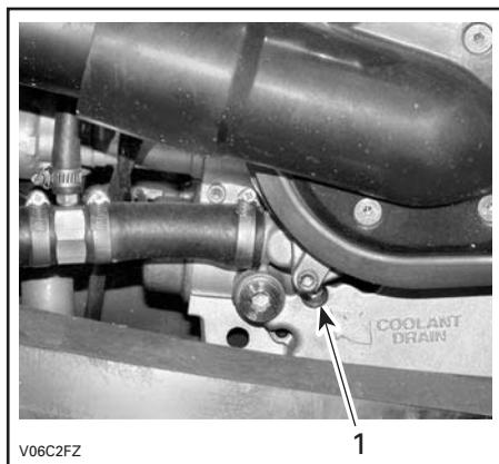
1. Bouchon de vidange du liquide de refroidissement
