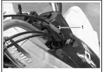
*REGOLAZIONE DALLA LEVA DELL'ACCELERATORE AL LIMITATORE DI APERTURA ACCELERATORE*
