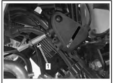
*REGOLAZIONE DAL LIMITATORE DI APERTURA ACCELERATORE AL MOTORE*
