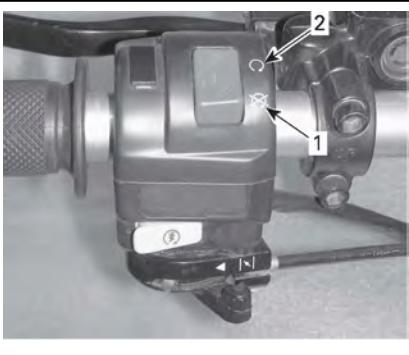
**ТИПОВОЙ ВАРИАНТ — ВЫКЛЮЧАТЕЛЬ АВАРИЙНОГО ОСТАНОВА ДВИГАТЕЛЯ**
