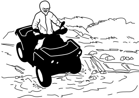
Попадание воды на тормозные механизмы оказывает неблагоприятное влияние на эффективность тормозной системы. После преодоления водной преграды, движения по грязи или снегу просушите тормозные колодки, несколько раз приведя тормоза в действие.
