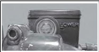
ЛЕВЫЙ ЗАДНИЙ БАЧОК ДЛЯ ТОРМОЗНОЙ ЖИДКОСТИ
