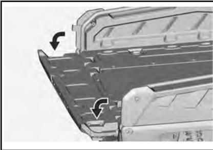
3. Coloque las abrazaderas de soporte de la puerta trasera.
