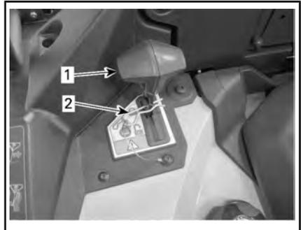
1. Tirador de desbloqueo de la plataforma de carga
