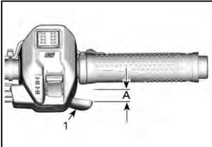
1. Palanca del acelerador
