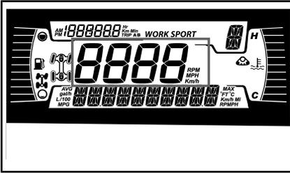
Muestra la velocidad del vehículo en km/h o mph.
