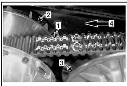
1. Flèche imprimée sur la courroie
