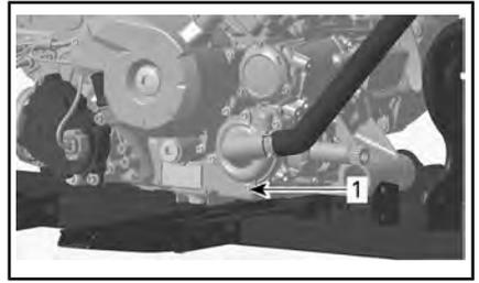
1. Bouchon de vidange du liquide de refroidissement
