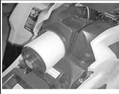
DÉPOSE DU FILTRE À AIR
