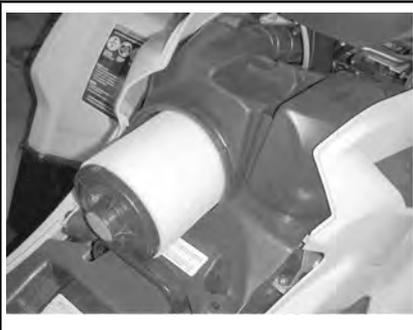
*RIMOZIONE DEL FILTRO DELL'ARIA*
