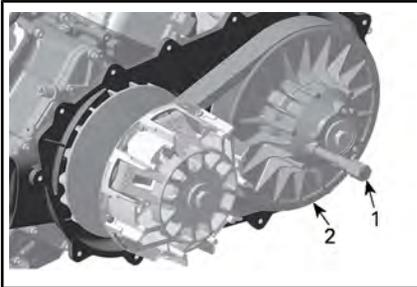
1. Strumento di traino/bloccaggio
