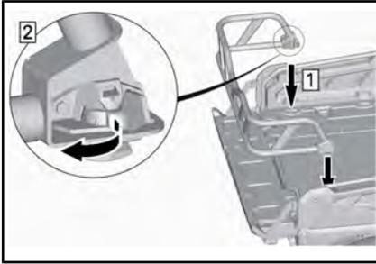
5. Installare l'estensione del vano di carico posteriore.
