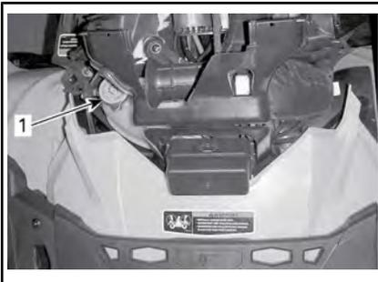
1. Tappo del serbatoio liquido refrigerante motore
