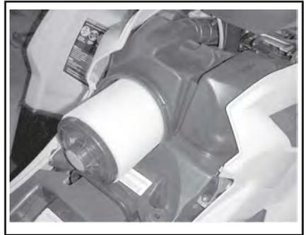
**RIMOZIONE DEL FILTRO DELL'ARIA**
