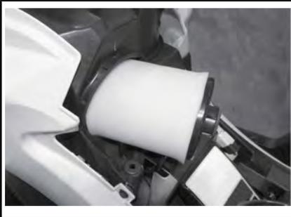
RIMOZIONE DEL FILTRO DELL'ARIA
