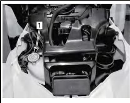
1. Tappo del serbatoio liquido refrigerante motore
