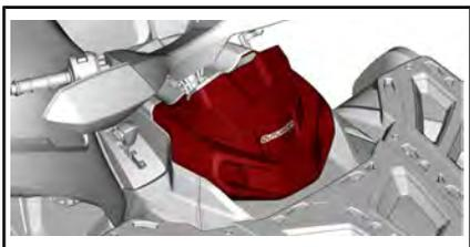
Rimuovere il tappo del serbatoio del liquido refrigerante motore.
