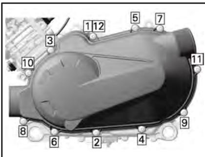
**SEQUENZA DI SERRAGGIO DELLA CARENATURA DELLA CVT**
