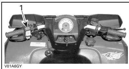
1. Interrupteur multifonctionnel
