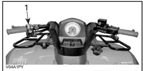
1. Interrupteur multifonctionnel
