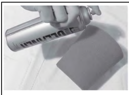
ТИПОВОЙ ВАРИАНТ – НАНЕСЕНИЕ МАСЛА НА ПОРОЛОНОВЫЙ ФИЛЬТР
