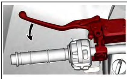
A frenagem é proporcional à força aplicada na alavanca.
