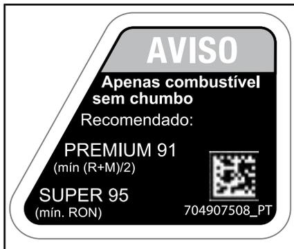
*PRÓXIMO À TAMPA DO TANQUE DE COMBUSTÍVEL DOS MOTORES 1000R*
