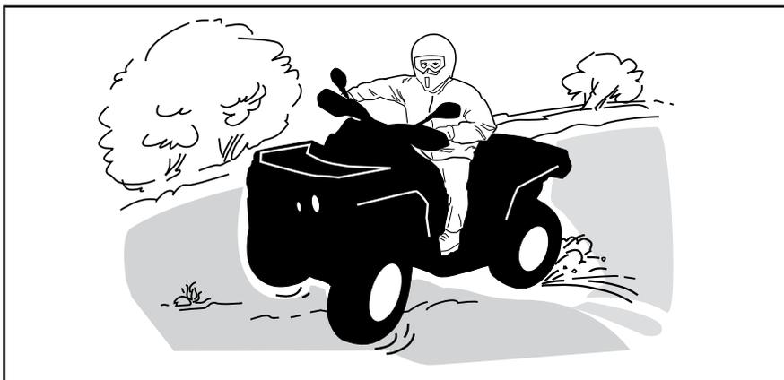
Se você deslizar ou derrapar, virar o guidão na direção do movimento pode ajudar a recuperar o controle do veículo. Nunca freie com força e trave as rodas.
