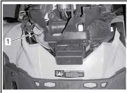
1. Reservatório do líquido de arrefecimento do motor
