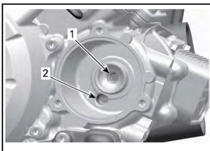
1. Furo de saída para o sistema de alimentação de óleo do motor
