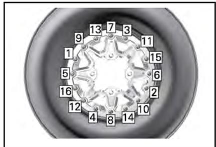
ТИПОВОЙ ВАРИАНТ - ПОРЯДОК ЗАТЯЖКИ ВИНТОВ
