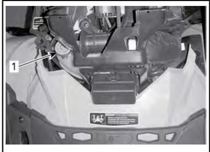
1. Крышка расширительного бачка системы охлаждения двигателя
