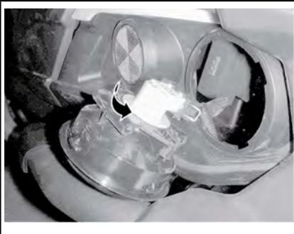
Отсоединить электрический разъем лампы от заднего фонаря.
