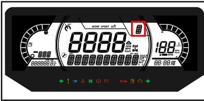
Diese Anzeige zeigt die Getriebestellung an:
