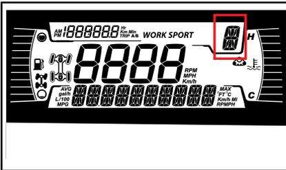
Diese Anzeige zeigt die Getriebesstellung an:
