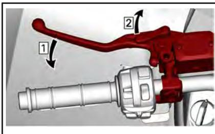
Schritt 1: *Betätigen Sie die Bremsen*
