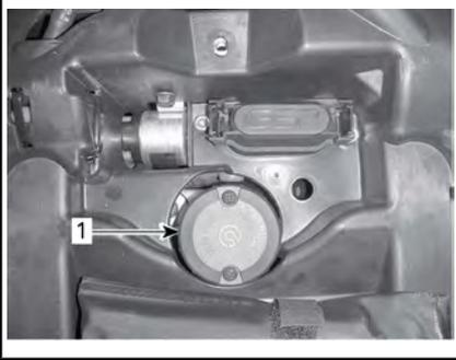
1. Behälter für Bremsflüssigkeit der hinteren Bremse
