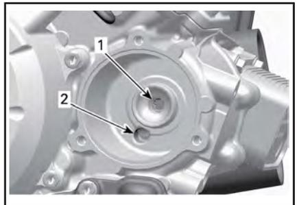
1. Auslass-Bohrung zur Ölspeisung des Motors
