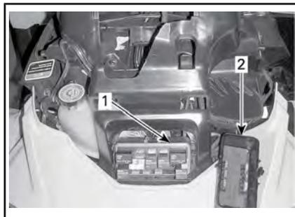
1. Vorderer Sicherungskasten
