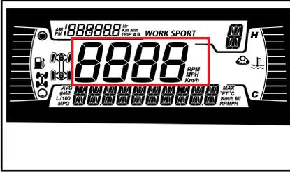
Anzeige der Fahrzeuggeschwindigkeit in km/h oder mph.
