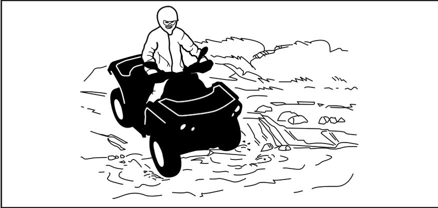
Nasse Bremsen beeinträchtigen die Bremsleistung Ihres Fahrzeugs. Sorgen Sie durch mehrfaches Betätigen dafür, dass Ihre Bremsen wieder trocken werden, nachdem das Fahrzeug das Wasser, Schlamm oder Schnee verlassen hat. Achten Sie beim Bremsen auf einen größeren Abstand.
