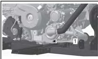
1. Bouchon de vidange du liquide de refroidissement
