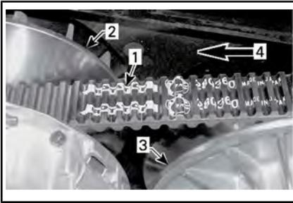
1. Flèche imprimée sur la courroie
