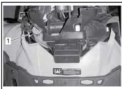
1. Tappo del serbatoio liquido refrigerante motore
