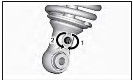
*SMORZAMENTO IN ESTENSIONE - PARTE INFERIORE DELL'AMMORTIZZATORE*
