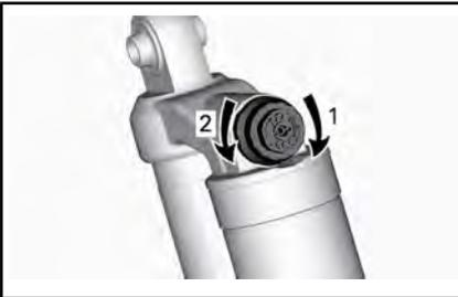
*SMORZAMENTO IN COMPRESSIONE - PARTE SUPERIORE DELL'AMMORTIZZATORE*
