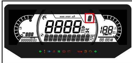
Diese Anzeige zeigt die Getriebebestellung an:
