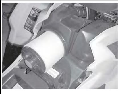
**DÉPOSE DU FILTRE À AIR**
