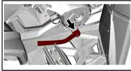
Wenn es losgelassen wird, sollte das Bremspedal automatisch wieder in die Ausgangsstellung zurückkehren.
