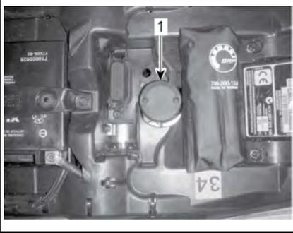
1. Behälter für Bremsflüssigkeit der hinteren Bremse
