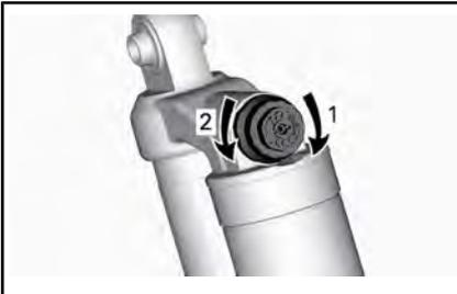
*DRUCKSTUFENDÄMPFUNG - OBEN AM STOSSDÄMPFER*
