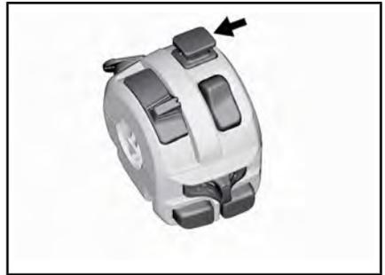
Нажмите на выключатель вниз, чтобы включить аварийную сигнализацию. Отожмите его вверх, чтобы выключить аварийную сигнализацию.
