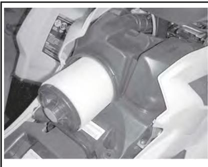
**СНЯТИЕ ВОЗДУШНОГО ФИЛЬТРА**
