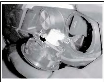
Отсоединить электрический разъем лампы от заднего фонаря.
