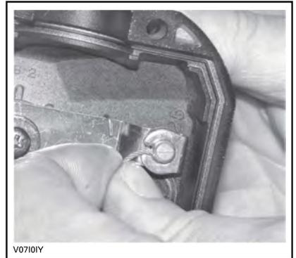
Entfernen Sie die Seitenabdeckung der Drosselklappe.
