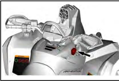
La palanca de cambios se utiliza para cambiar de marcha.
