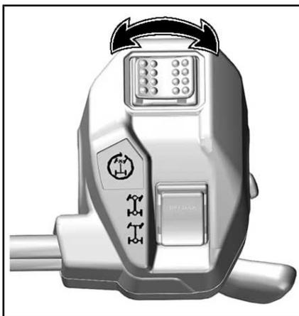
El modo SPORT ofrece una respuesta más puntual de la aceleración. Pulse IZQUIERDA para activar, DERECHA para desactivar.
