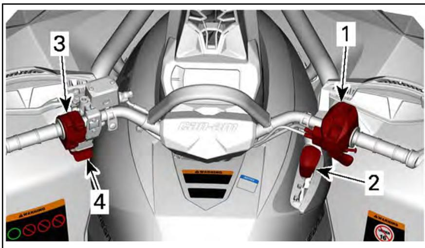
1. Alloggiamento del comando della leva dell'acceleratore
