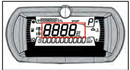
Visualizza la velocità del veicolo in KM/h o in MPH.
