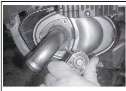
*CONFIGURAZIONE TIPICA - RIMUOVERE IL TUBO DI CODA*
