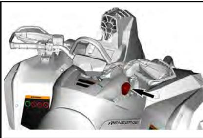
La leva del cambio è utilizzata per cambiare la posizione della scatola del cambio.
