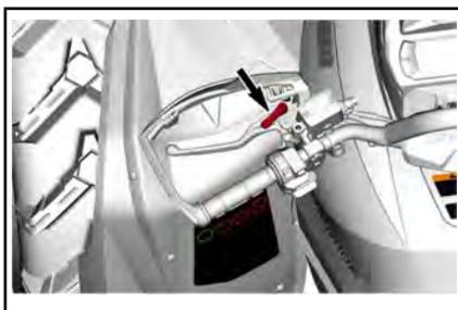
La funzione del freno di stazionamento consiste nel frenare tutte le ruote per impedire al veicolo di spostarsi quando è parcheggiato.
