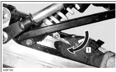
1. Partendo dalla posizione più alta ruotare il dispositivo di regolazione per selezionare la posizione più bassa, quindi ruotarlo fino alla posizione desiderata.
